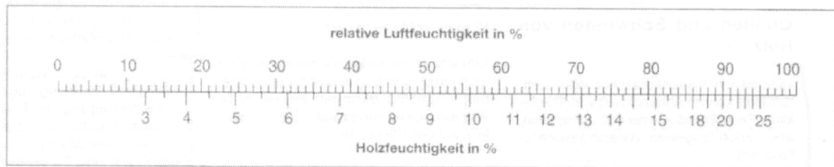
Bild: Resorptionsfeuchtigkeit bei einer Raumtemperatur von +20° C
